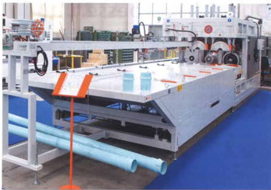
PVC-O Muffenformmaschine für Rohre bis zu 250 mm Durchmesser PVC-O belling machine up to 250 mm
