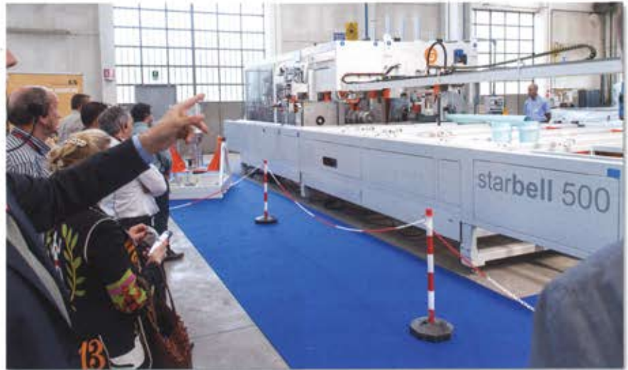
PVC-O Muffenformmaschine für Rohre bis zu 500 mm Durchmesser PVC-O belling machine up to 500 mm (Images: SICA)
