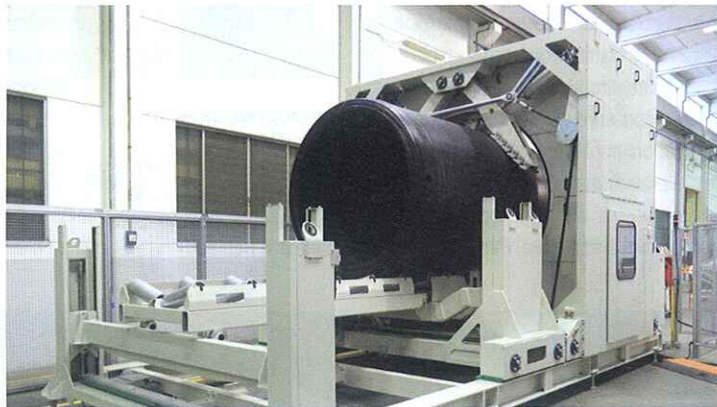
La taglierina TRK/C 2500 è progettata per il taglio, in linea di estrusione, di tubi in PE con diametro da 710 a 2540 mm, senza asportazione di materiale
